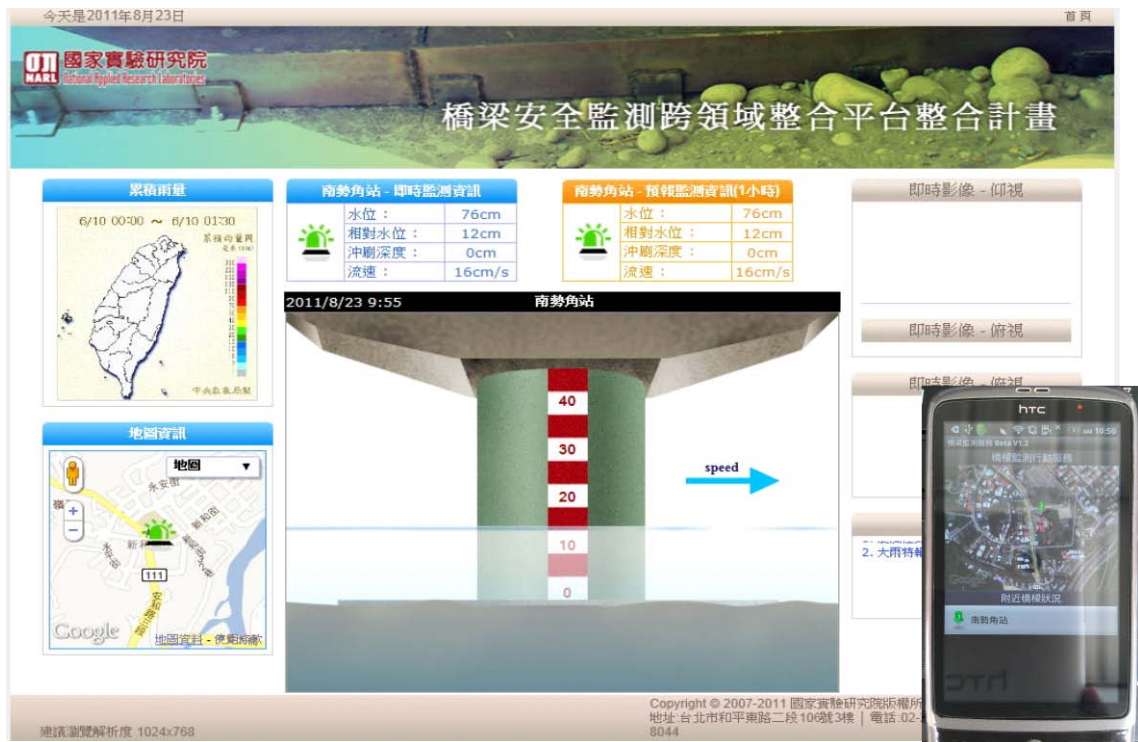
圖 5、橋梁防救災手機即時監測與檢測影像平台
