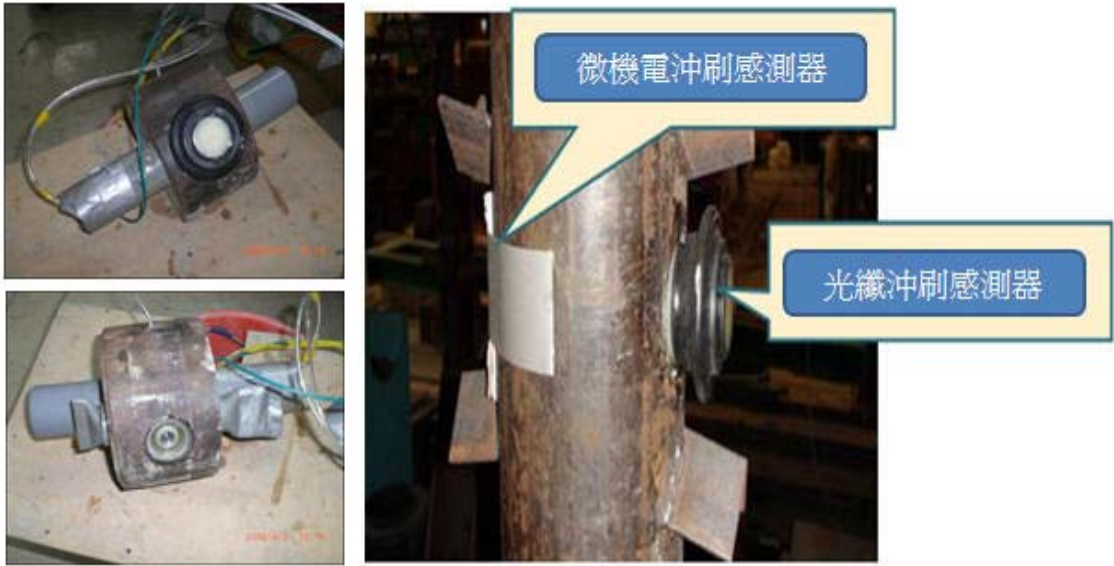
圖 1、光纖及微機電製程感測沖刷計
